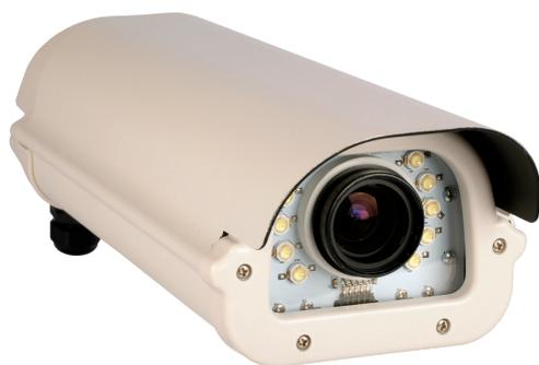
Работа всех компонентов, входящих в состав термокожуха: светодиодной подсветки (обогрева), вентиляторов, IP-камеры, обеспечивается дистанционным питанием по информационной паре с использованием технологии PoE. Комплекуются белыми или ИК светодиодами. Обогрев зон внутри кожуха, критичных к перепаду температуры (зона стекла и зона объектива), обеспечивается за счет мощности, рассеиваемой на светодиодах.
