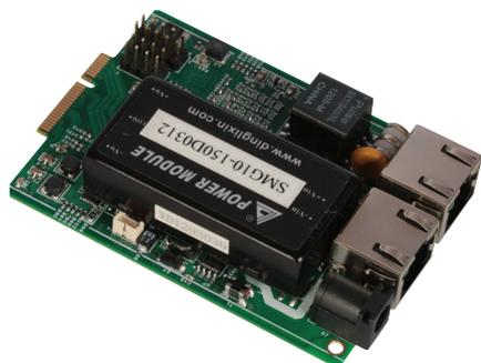
SHDSL модуль, встраиваемый в IP-камеру Sigrand, позволяет передавать видеоизображение между камерой и SHDSL интерфейсами на дальние расстояния. Максимальная скорость – до 15296 кбит/с по одной паре. Совместимость по линейному интерфейсу: с модемами SG-17B, модулями MR-17H\*, MS-17H\*. Устанавливаются в камеру вместо Ethernet интерфейса.
